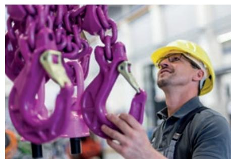
**Atención:** ¡si ensambla soportes usted mismo, debe utilizar para ello únicamente eslingas de cadena! Las cadenas de amarre no están autorizadas para elevar, ya que cuentan con un factor de seguridad diferente al de las eslingas de cadena.
